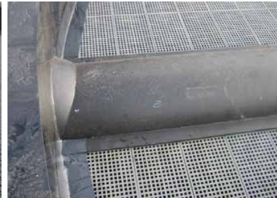
Das Gitterrostboden-System als Belüftungs- bzw. Anströmboden
