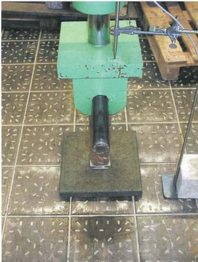
Abbildung 1: Belastungsversuch mit starrem Auflager
