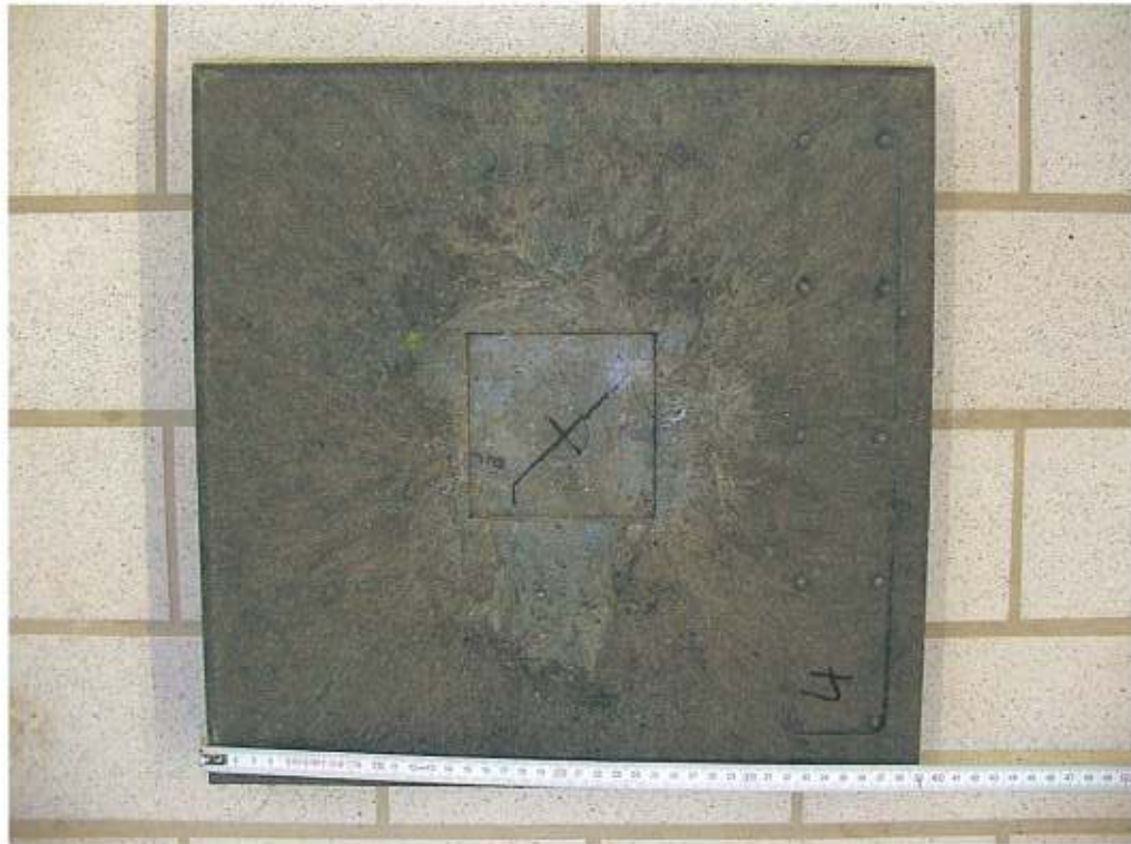
Abbildung 3: Kunststoffplatte, Dicke 5 cm, nach Prüfung auf starrer Unterlage. Deutlich erkennbar ist der Eindruck der Lastplatte in der Mitte des Prüfkörpers.
