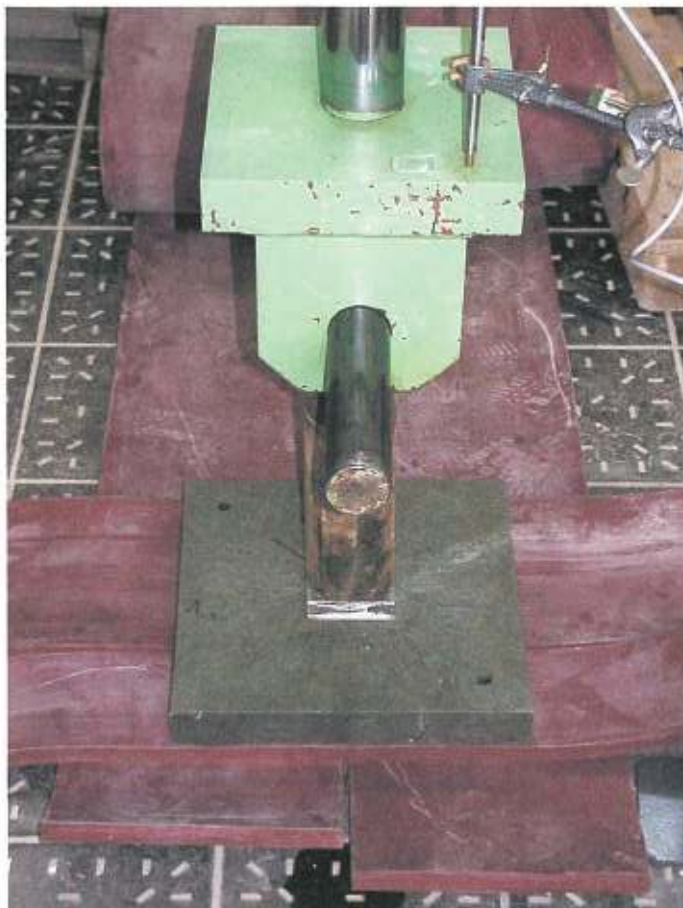
Abbildung 2: Belastungsversuch mit elastomerem Auflager.
