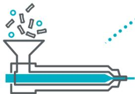
Les granulés sont fondus dans un extrudeur et injectés dans des moules. Nous ajoutons de la couleur au plastique en fusion.
